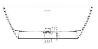
\* Расположение стандартного технологического отверстия на задней стенке. В базовую комплектацию не входит, заказывается отдельно.
